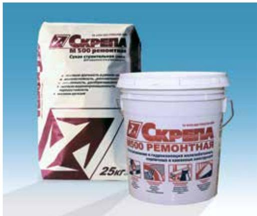
5.2 «Скрепа М500 Ремонтная» (ТУ 5745-003-77921756-2006) – Сухая строительная ремонтная и гидроизоляционная поверхностная смесь. Состоит из портландцемента, кварцевого песка определенной granulometрии, запатентованных химических добавок и армирующего фиброволокна.
